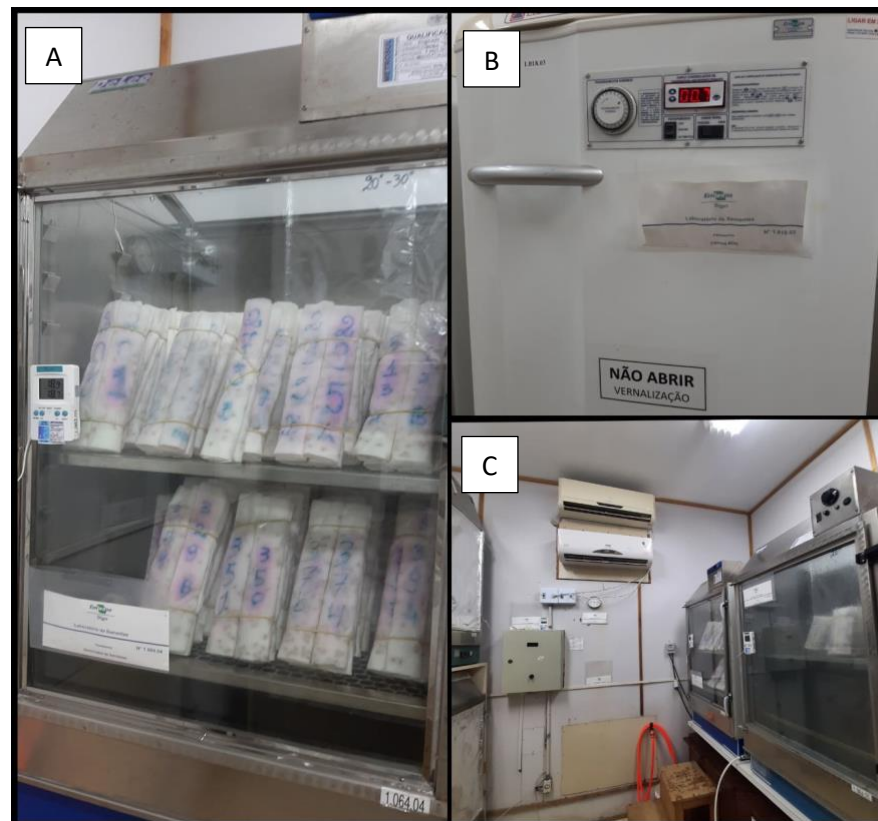
Figura 8 – Equipamentos utilizados para a germinação a) Germinador, b) Estufa para germinação com termoperíodo e fotoperíodo, c) Câmara de germinação
