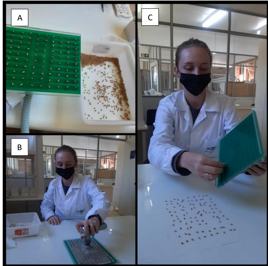
Figura 6 – Semeador a vácuo a) Sementes distribuídas sobre a placa, b) Placa colocada sobre o substrato, c) Sementes distribuídas sobre o substrato após a interrupção do vácuo
