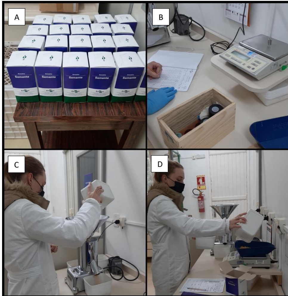
Figura 1 - Recebimento e homogeneização das amostras a) Amostras recebidas pelo laboratório, b) Checagem da balança, c) Homogeneização da amostra em divisor centrífugo tipo Gamet d) Pesagem para verificar se o peso mínimo foi atingido
