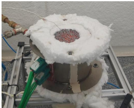
Chama submersa posicionada na parte inferior do queimador.
