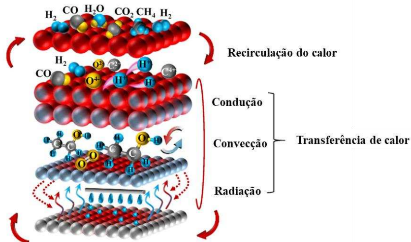
Figura 15 - Processo de transferência de calor em um queimador poroso de duas camadas com injeção de etanol.
