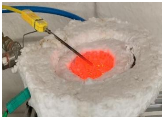
Figura 20 - Termopar tipo K posicionado na superfície do queimador.
