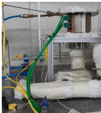
Entrada de reagentes, parte inferior do queimador.
