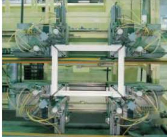
Figura 15 – Montagem dos Cantos soldados de uma esquadria Fonte: Braskem, 2002.
