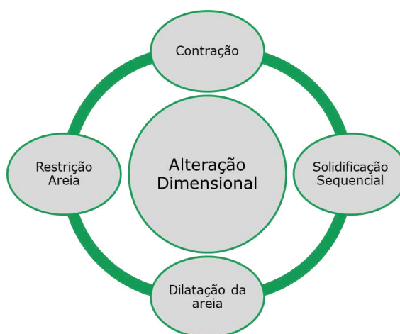
Figura 1 – Comportamentos causadores de distorção em peças fundidas mais estudados
