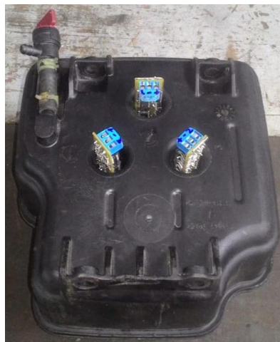
Figura 4 – Vista inferior do tanque de combustível com os sensores parcialmente alocados.
