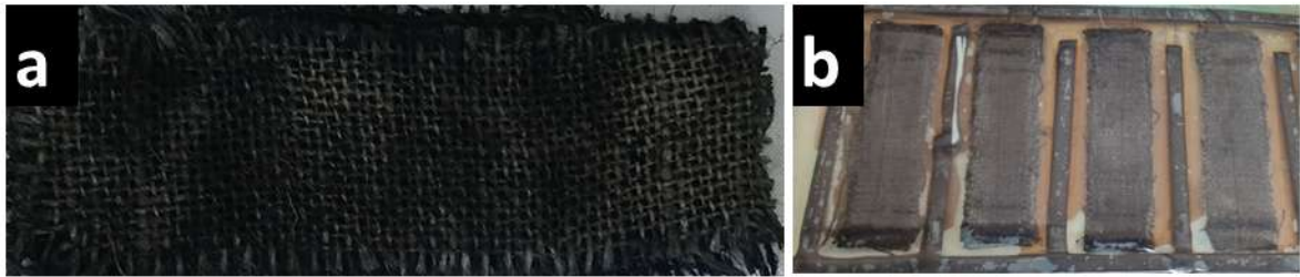
Figura 19 – Metodologia de fabricação adotada para obter JFEC com fibras na forma de tecido: a) JF posicionadas b) aplicação da resina e vácuo.
